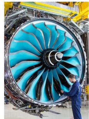
Carbon titanium fan blade
